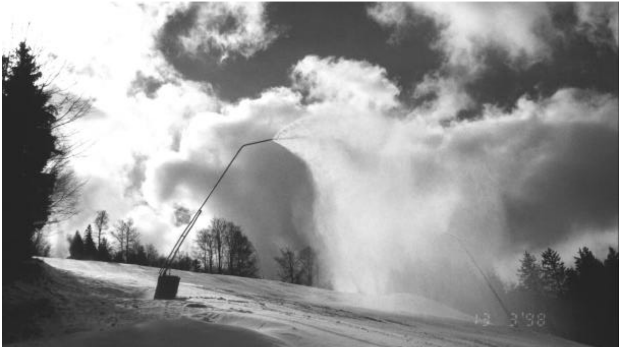
Betrieb der HKD-Beschneigungsanlage an der FIS-Strecke, Fahl / Feldberg
